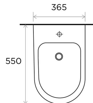
Debido a la simplicidad del concepto de instalación a pared. La instalación se logra conectando la entrada/salida de agua con el mecanismo de descarga y asegurando el inodoro con el kit de fijación incluido.
