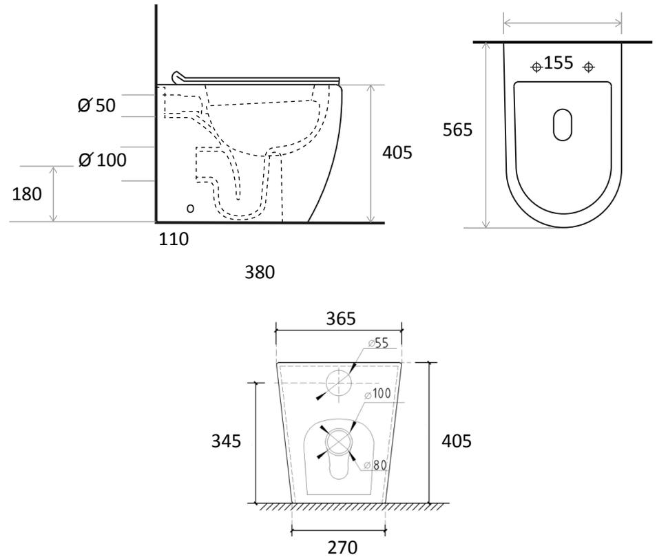
Debido a la simplicidad del concepto de instalación a pared. La instalación se logra conectando la entrada/salida de agua con el mecanismo de descarga y asegurando el inodoro con el kit de fijación incluido.
