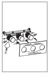
INSTALL THE ROUND LID OF THE EMBEDDED BOX. SEAL THE WALL AND LAY TILES (NOTE THE SIZE THE TILE OPENING).
